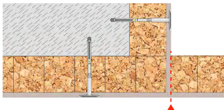
Figura 16 Realizzazione di angoli nel sistema Betontherm
